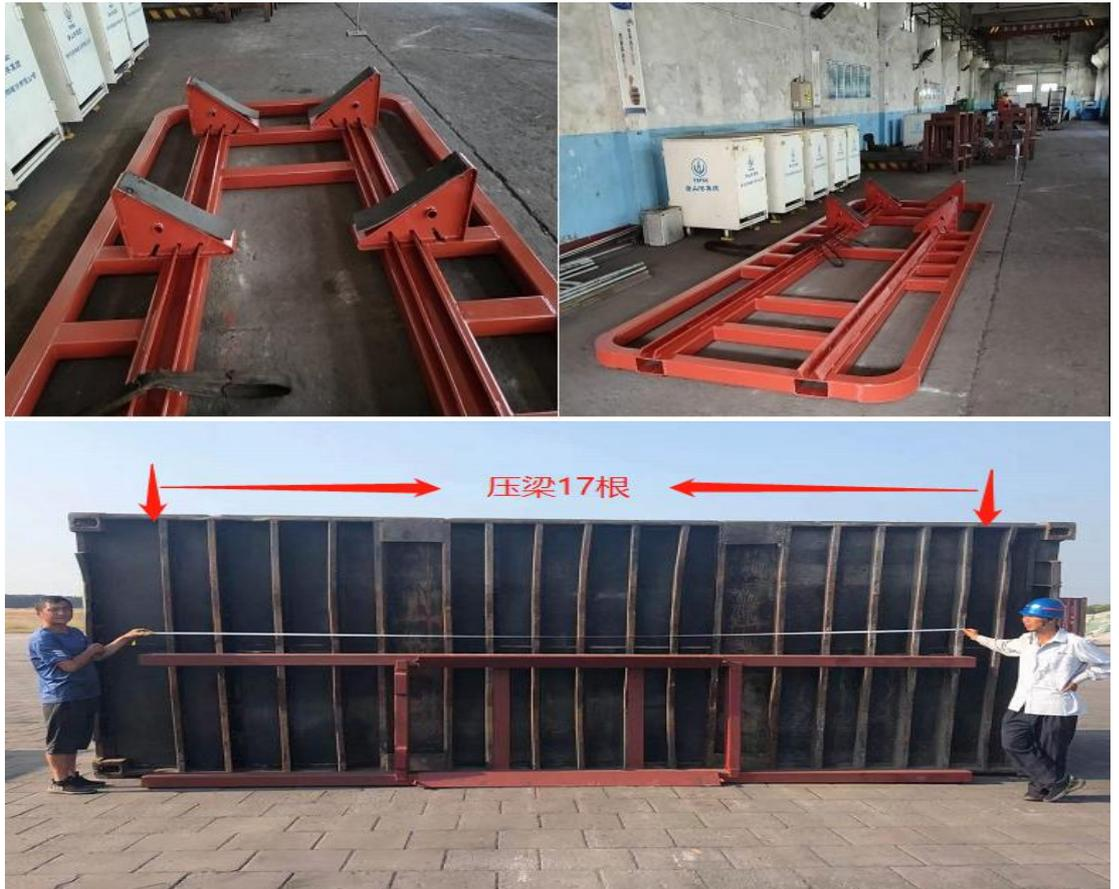
C: 请务必确保卷(带)钢货物在集装箱内纵向中轴线上积载, 纵向平均分配重量、合理衬垫、绑扎。
